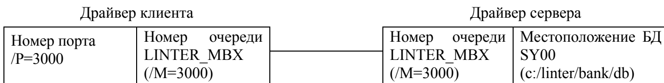
Рис. 15. Схема взаимодействия сетевого и клиентского драйверов
